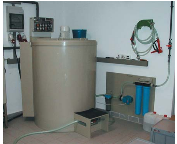
Abb.: 1.000-Liter-Produktionstank mit Filtration
